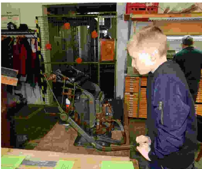
Der Hebel wird wieder nach oben geführt und lässt den Tiegel aufklappen. Gleichzeitig rollen die zuvor eingefärbten Farbwalzen über den Druckstock und färben diesen frisch ein. Ebenfalls bekommt der Farbteller die für einen Druckvorgang notwendige Farbmenge aus dem Farbkasten zugeteilt, um damit die Farbwalzen wieder mit neuer Farbe zu bestücken.
