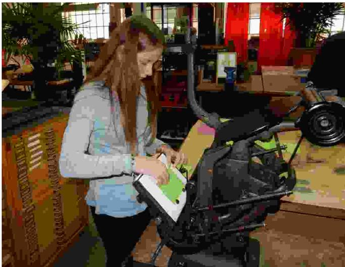
Mit dem nach unten gedrückten Hebel presst der Drucker den Papierbogen im Tiegel gegen den Druckstock im Fundament und bedruckt ihn. Der Hebel bewegt gleichzeitig auch zwei Walzen über den Farbteller und lässt sie neue Farbe aufnehmen.
